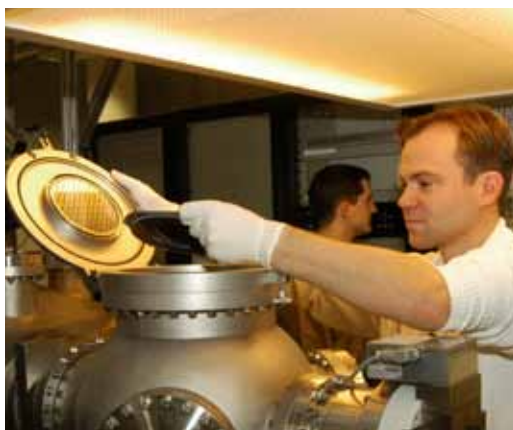
Próźniowe pokrywanie substratu w aparaturze utwardzającej
